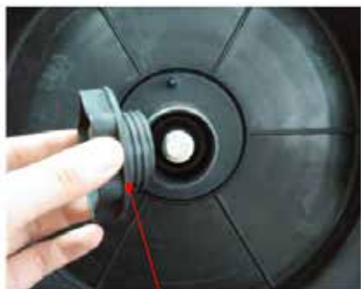
1. Rimuovere la ghiera serra bobina
