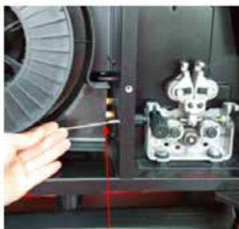
4. Inserire il capo del filo all'interno della canula di guida e spingere fino all'ingresso nella prima coppia di rulli
