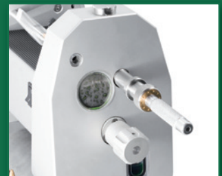
Elektrodavágás a fogantyú elforgatásával.
